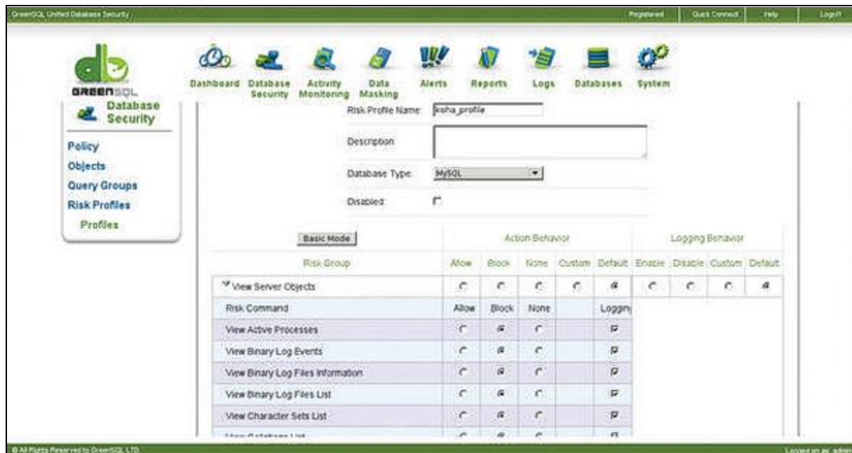
Рис. 4. Профили риска предоставляют администраторам более точно установить, какие операции с базой данных разрешить, а какие запретить
